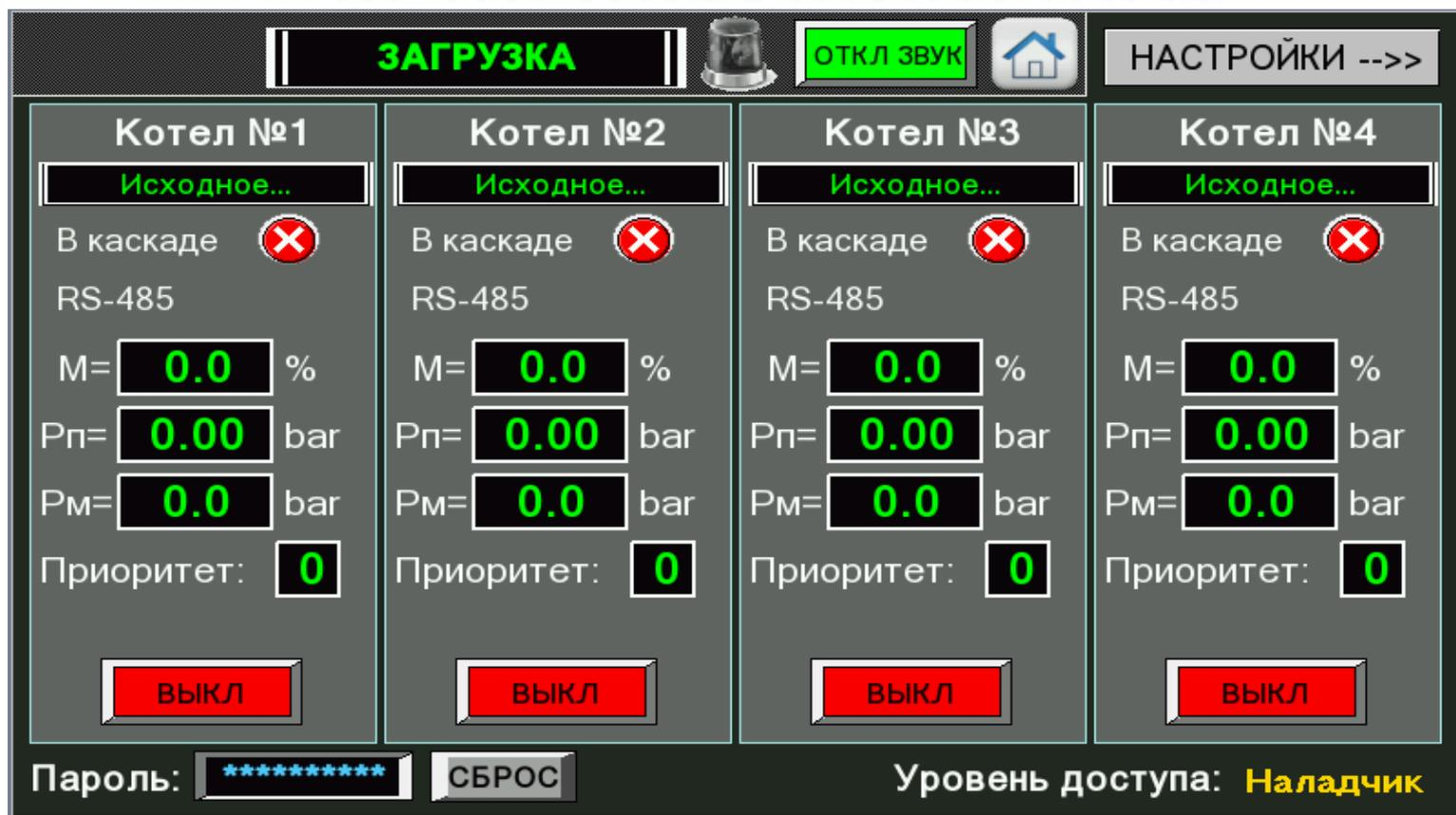
Рисунок 1. Общий вид главного экрана общекотлового щита
